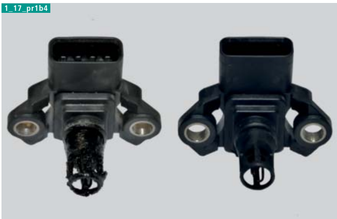
Bild 4. Der Saugrohrdruck-/Temperatursensor vor und nach der Reinigung.
